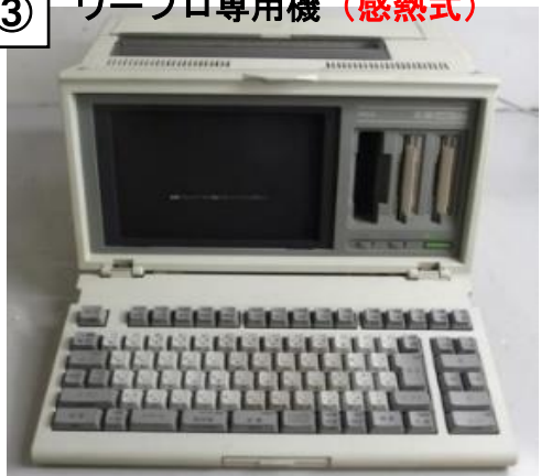
ワープロ専用機（感熱式）
