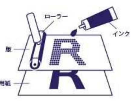
ガリ版(騰写版)とは、明治時代に生まれ、小・中規模の印刷に大活躍した簡易印刷機のことです。鉄製のヤスリ板を下敷きにロウ原紙を載せ、その表面に鉄筆で文字を書き、鉄筆により開いた微細な孔からインクが押し出され、文字が印刷されます。文字を書く際の「ガリガリ」という音からその名が付いたとされています。
