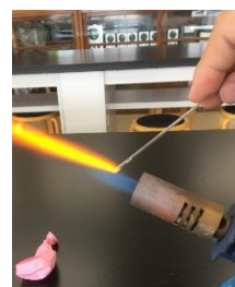
図 2 バーナーで片側を閉じている様子
