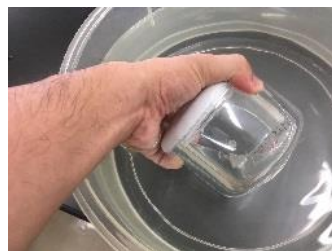
図1 簡易真空容器内に水が流入している
