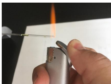
図 3 ターボライターで毛細管の片側を閉じている様子
